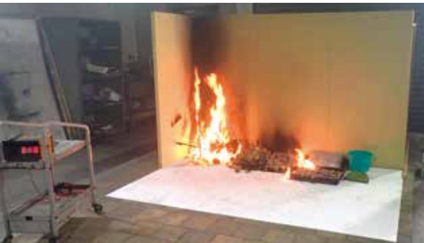
火災再現実験
