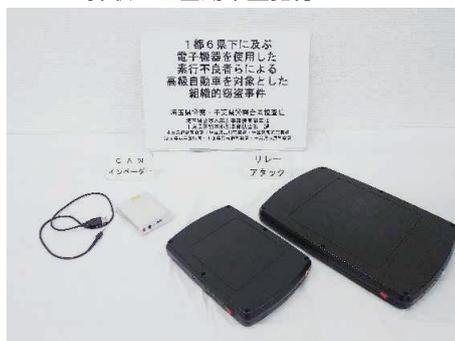
【CANインベーター】 エンジン等を制御するネットワークシステムに侵入し、エンジンを起動させる装置
