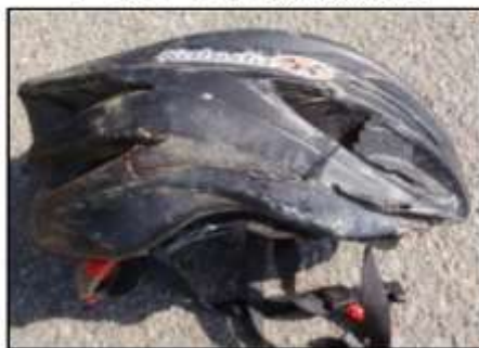
【ヘルメットの損傷状況】
